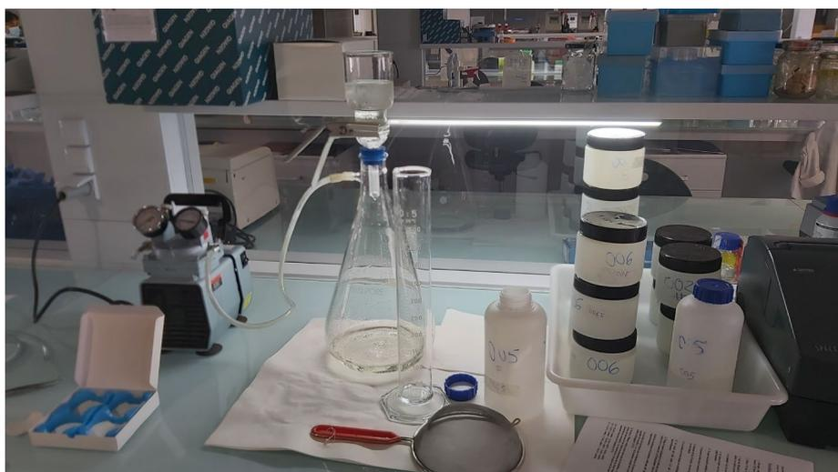
**Figura 10.** Sistema de filtración con membranas filtrantes al vacío utilizado para la extracción de la clorofila de las muestras de agua.
