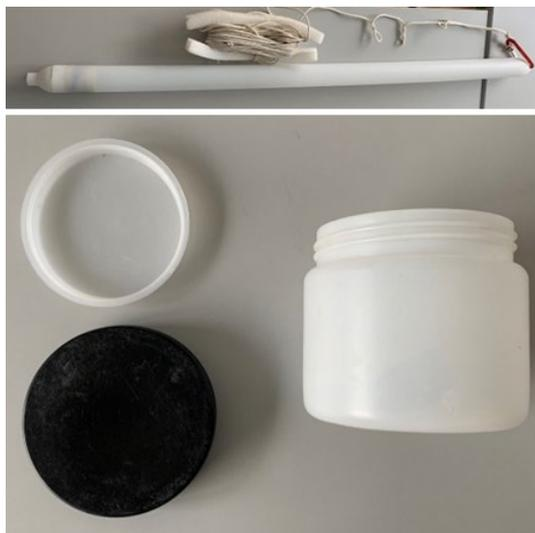
**Figura 6.** Arriba, muestreador de aguas bailer utilizado en el proyecto. Abajo, botes de almacenaje de las muestras de agua de los embalses.
