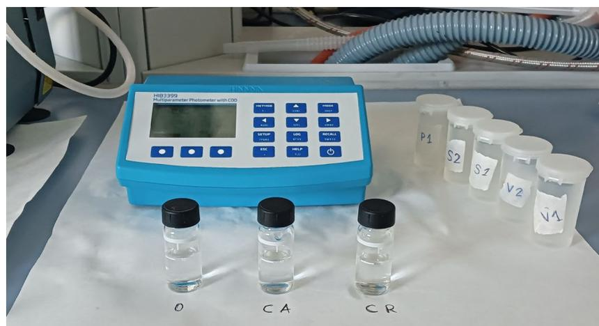
**Figura 14.** Medidas en el laboratorio con el fotómetro multiparamétrico del color real y color aparente de las muestras de campo.
