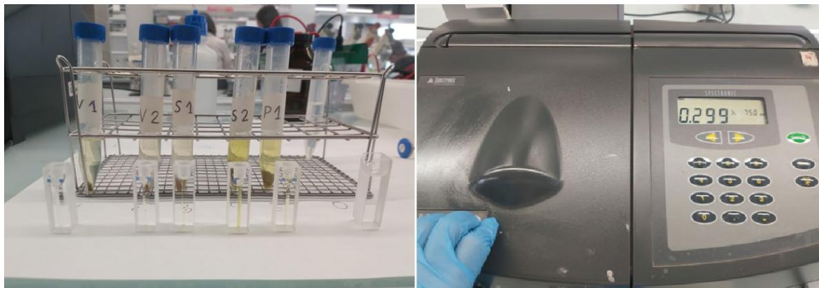
**Figura 12.** Izquierda, muestras filtradas preparadas en las cubetas de cuarzo. Derecha, medida de la absorbancia a 750 nm de una muestra en el espectrofotómetro.
