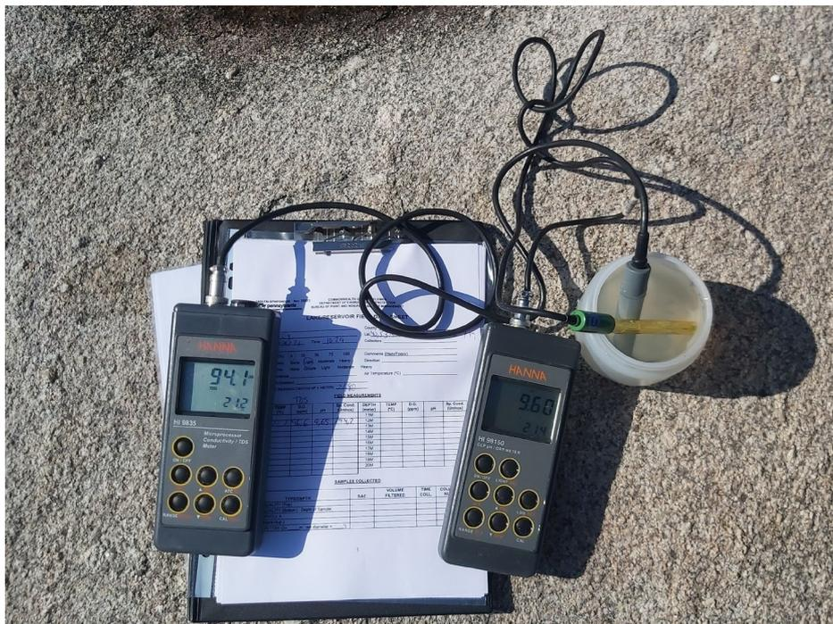
**Figura 8.** Material de muestreo y toma de datos in situ con las sondas multiparamétricas.
