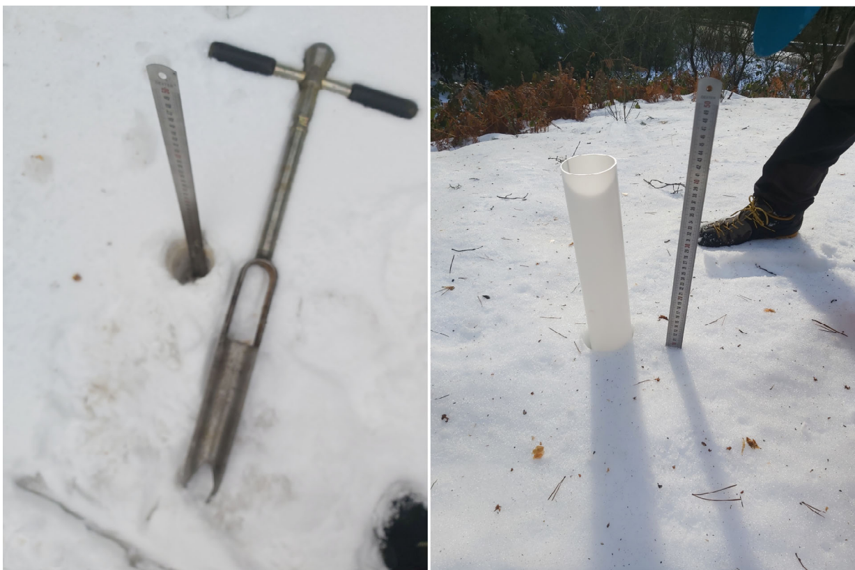
Figura 3. Muestreo en las campañas nivales del proyecto en el que se mide el espesor de acumulación nival y la recogida de muestras para el cálculo del agua de nieve equivalente (SWE).
